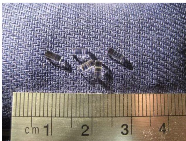
Рис. 10. Градиентные микролинзы, чувствительные к воздействию влаги.
