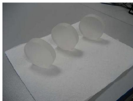
Рис.2. Сапфировые диски до и после очистки
