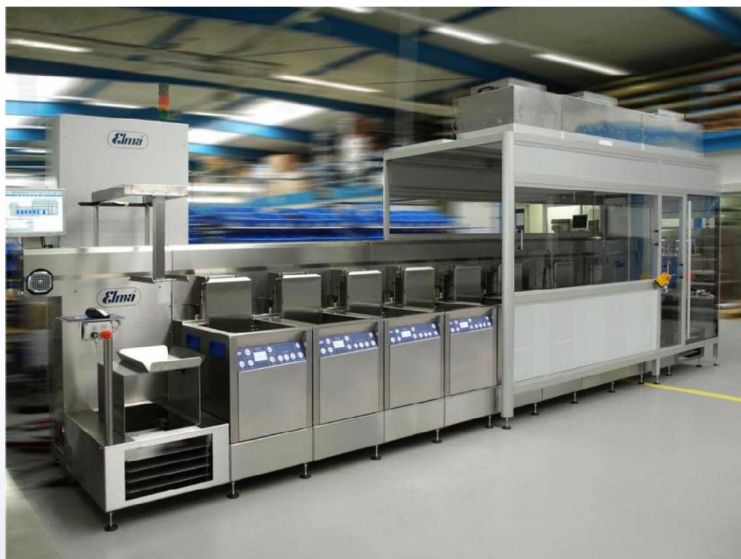
Рис. 9. Модульная ультразвуковая линия Elmasonic X-tra line Precision для финишной очистки оптических деталей.
