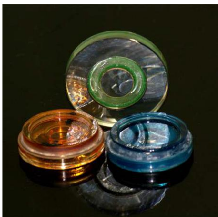
Рис.3. Внешний вид оптических деталей после полировки
